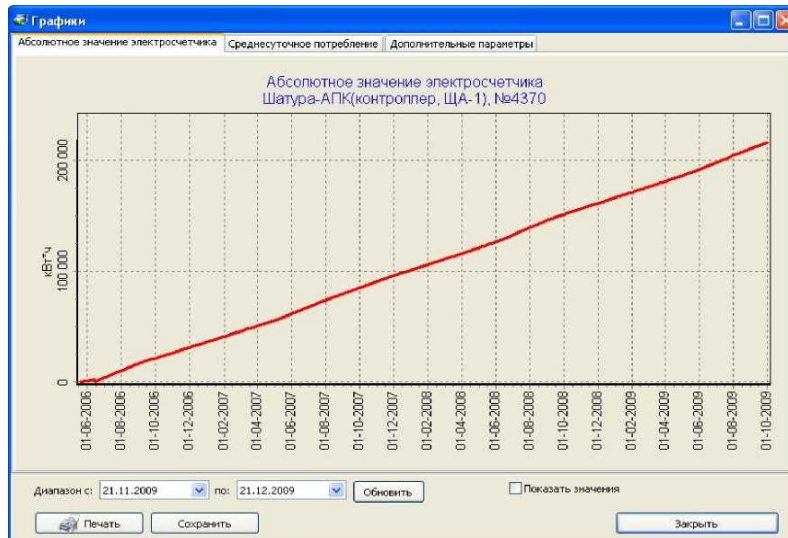
Рисунок 19. Абсолютное значение электросчётчика
