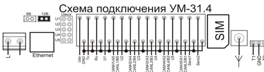
**Рисунок 7. Обозначение клеммников**
