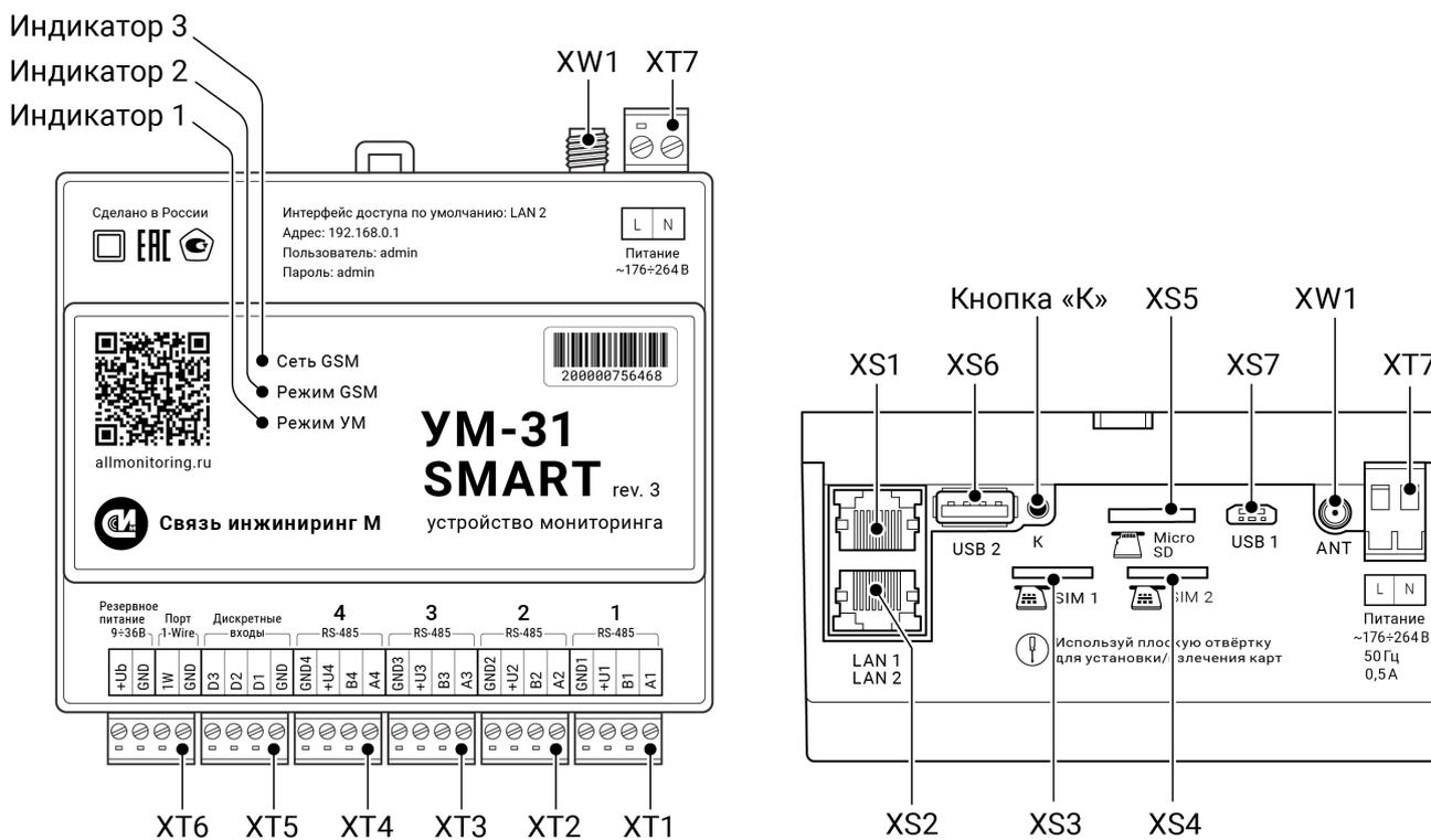
Рисунок 2 – Расположение клеммников, индикаторов и кнопок
