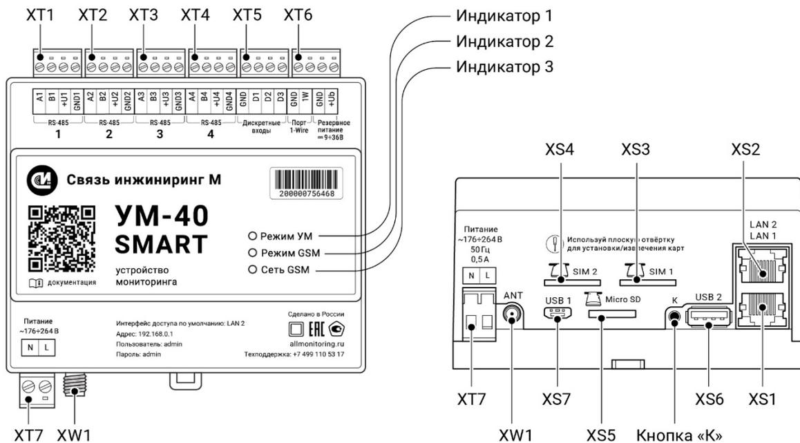
Рисунок 3 – Расположение разъёмных соединителей, индикаторов и кнопок
