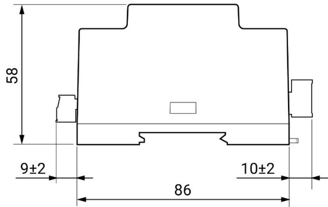
Рисунок 1 – Габаритные размеры УМ
