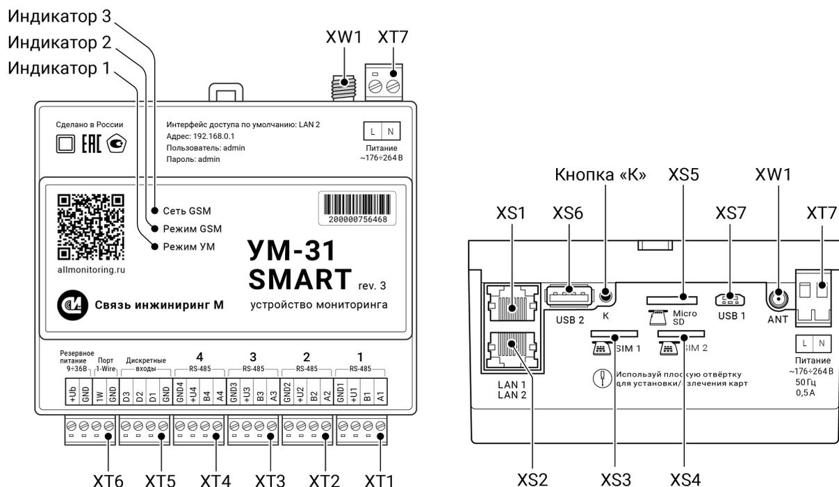
Рисунок 3 – Расположение разъёмных соединителей, индикаторов и кнопок
