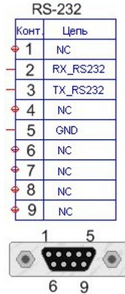
Рисунок 1. Описание разъёма RS-232
