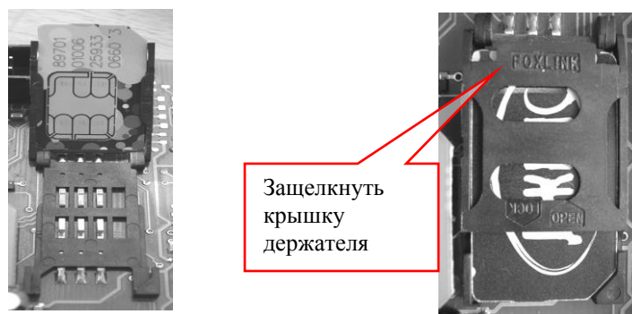
Рисунок 2. Установка SIM карты в держатель
